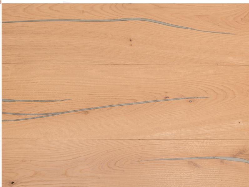
Eichendiele im 3-Schicht Aufbau mit kleiner Fase an der Langsseite und ca. 4 mm Laufschiene, sowie ca. 4 mm Gegenzug ausgleicher Holzart, dazwischen Weichholzmittellage. Allseits Nut und Feder zur endlosen Verlegung. Farbabweichungen, sowie seitliche Splintanteile sind möglich. Kleine offene Risse und ungekittete Stellen im Millimeterbereich sind zulässig. Risse, Ausfallaste und grose Aste werden mit Kitt betont.
