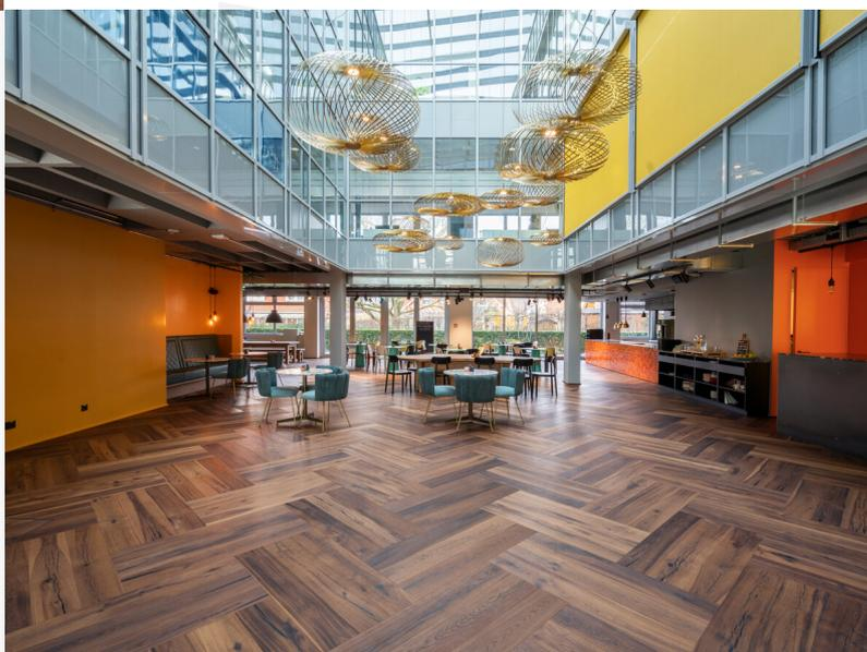
Colore omogeneo grazie al trattamento ad alta temperatura (senza additivi chimici). Listoni in rovere con struttura a 3 strati con leggera bisellatura lungo i lati. Strato di legno nobile ca. 3,5 mm, controbilanciatura in essenza di 4 mm ca., strato intermedio in legno tenero. Incastro maschio/femmina su tutti i lati per posa a correre. Sono possibili piccole fessure aperte e punti non stuccati al massimo di un millimetro e nodi fino a 25 mm di diametro.
