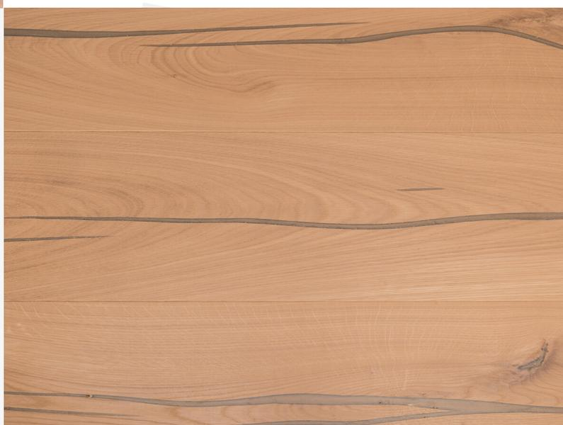
Eichendiele im 3-Schicht Aufbau mit kleiner Fasse an der Langsseite und ca. 4 mm Laufschiene, sowie ca. 4 mm Gegenzug ausgleicher Holzart, dazwischen Weichholzmittellage. Allseits Nut und Feder zur endlosen Verlegung. Farbabweichungen, sowie seitliche Splintanteile sind möglich. Kleine offene Risse und ungekittete Stellen im Millimeterbereich sind zulässig. Risse, Ausfallaste und grose Aste werden mit Kitt betont.
