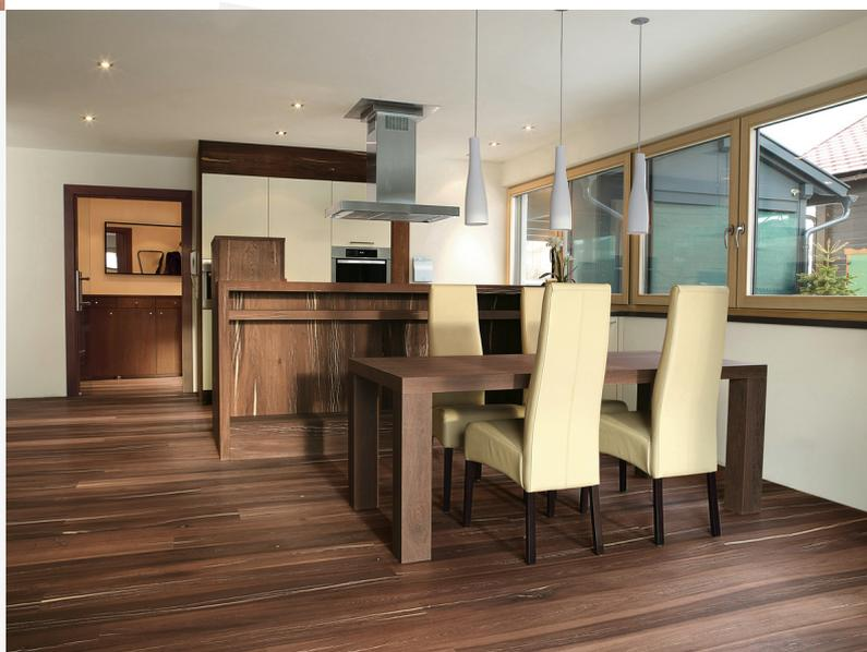
Eichenholz, das durch eine Wärmebehandlung (ohne chemische Zusätze) eine durchgängige Farbgebung aufweist. Eichendiele im 3-Schicht-Aufbau mit kleiner Fase an der Längsseite und ca. 3,5 mm Laufschiicht sowie ca. 4 mm Gegenzug aus gleicher Holzart, dazwischen Weichholzmittellage. Allseits Nut und Feder zur endlosen Verlegung. Kleine offene Risse und ungekittete Stellen im Millimeterbereich sind zulässig. Äste bis 25 mm Durchmesser und Splint sind möglich.
